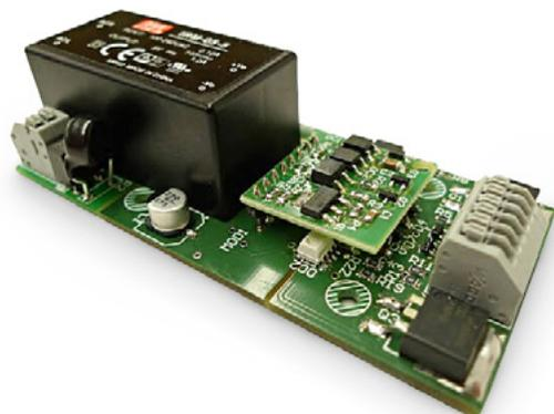
Das **DALI TW8** Modul ist ein DALI-kompatibles Gerät (Gerätetyp 8), speziell entwickelt für die Tunable-White-Kontrolle von LED-Modulen mittels DALI-Schnittstelle. Für die korrekte Funktion wird ein DALI LED-Driver benötigt (Wenn eine Helligkeitsregelung gewünscht wird).
